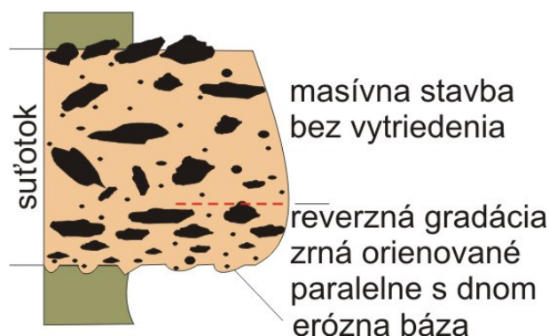
Obr. V.37: Znaky suťotoku v sedimentárnom zázname. Typickým znakom je masívna stavba bez vytriedenia sedimentu. V spodnej časti sa často vyvíja reverzná gradácia a klasty sú orientované paralelne s dnom. Ak je povrch prepracovaný riečnym prúdom, môžeme pozorovať imbrikáciu.
